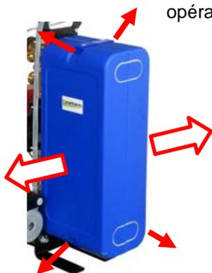
Déclipser les attaches en haut et en bas\* et séparer les 2 demi-coquilles\* pour enlever l'isolation.
