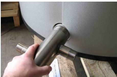
4. Monter la pièce entrée eau froide sur le piquage vertical inférieur. Le cas échéant, utiliser le manchon fourni si la tubulure ballon est mâle, de façon à pouvoir raccorder la pièce.
