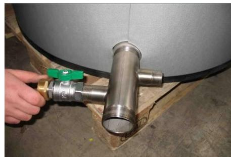
5. Une fois la pièce inférieure fixée, installer la vanne d'isolement et le raccord pour flexible.
