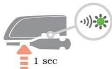
Zet de Rond in BIND-modus door de rechter aanraakknop onder het scherm 10 seconden ingedrukt te houden.
