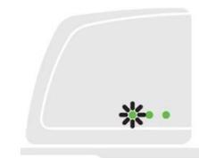
De Rond geeft dan voor een paar seconden verbindinginformatie en signaalsterkte weer (5= goed signaal) voordat het apparaat naar normale werking terugkeert.
