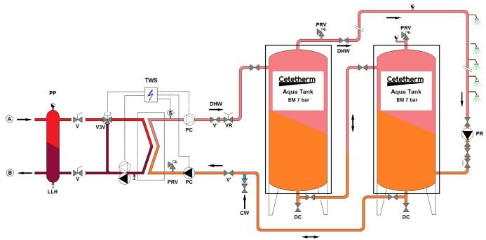
Α Entrée primaire В Sortie primaire CW Entrée eau froide Vanne de vidange DC DHW Eau Chaude Sanitaire Échangeur de chaleur à plaques ΗE PC Pompe de charge (1 ou 2)
